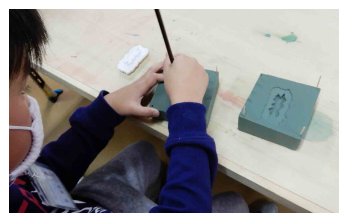
④できた原型をオアシスに押し付けて、鑄型を作ります。
